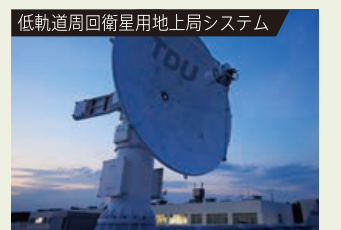
低軌道周回衛星用地上局システム 人工衛星で計測された情報を受信し、宇宙工学に関する研究や教育に活用しています。
