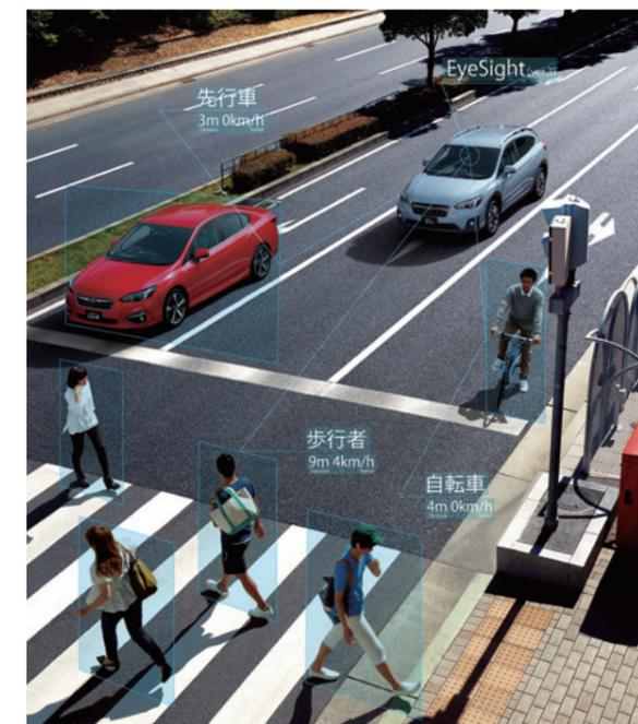
▲ステレオカメラで前方を捉えブレーキなどを制御して高度な運転支援を実現
