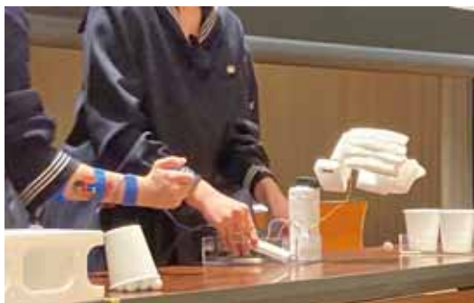
腕につけた筋電センサーで義手を操作している様子
