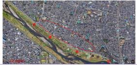
特徴: ①多摩川本川の水位が天端近くまで上がって、無堤区間で溢水が生じた。 ②支流や下水の水門、樋門を閉じた箇所と閉じなかった箇所があったようである。 ③右岸、左岸とも支流、下水で内水氾濫が発生した。
