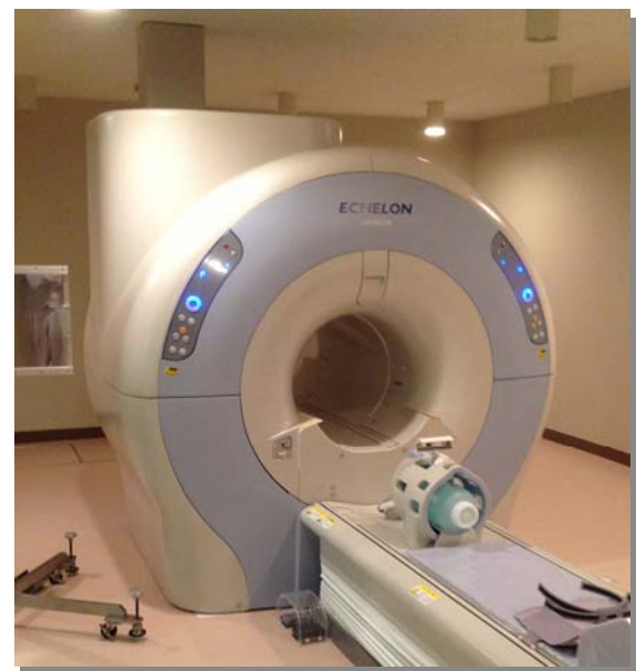
図 核磁気共鳴画像装置と測定環境 文科省補助金より、2014年に更新されたfMRI, 1.5T, 全身スキャナー(日立メディコ製: ECHELON Vega)
