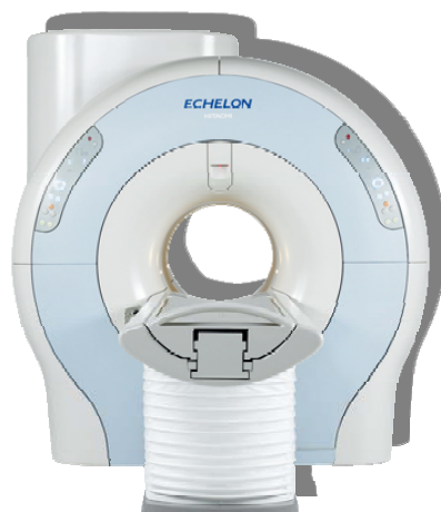
図 核磁気共鳴画像装置と測定環境 文科省補助金より、2014年に更新されたfMRI, 1.5T, 全身スキャナー(日立メディコ製: ECHELON Vega)
